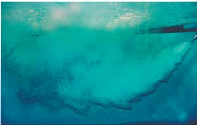
图为爱尔氧®275型曝气机在水下的搅拌效果
